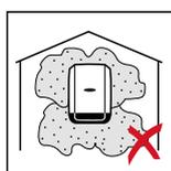
Grundsätzlich ist der Wechselrichter staubdicht ausgeführt. In Bereichen mit starker Staubansammlung können jedoch die Kühlflächen verstauben und somit die thermische Leistungsfähigkeit beeinträchtigen. In diesem Fall ist eine regelmäßige Säuberung erforderlich. Eine Montage in Räumen und Umgebungen mit starker Staubentwicklung ist daher nicht zu empfehlen.
