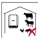
Den Wechselrichter nicht montieren in:
