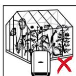
Den Wechselrichter nicht montieren in:
