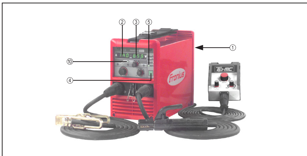
Fig. 21 Transtig 1600 / 1700 como aparelho de soldadura manual por eléctrodos composto por: fonte de alimentação com unidade de comando, regulador à distância manual TPmc (opcional) e cabos de soldar
