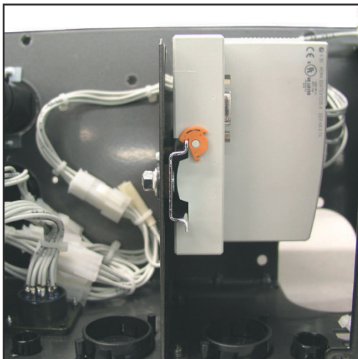
Coupleur de bus de terrain monté sur un profilé chapeau isolé - Série d'appareils TS/TPS, MW/TT
